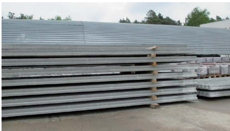
Fot. 3 Prawidłowe magazynowanie belek stropowych MASTER
