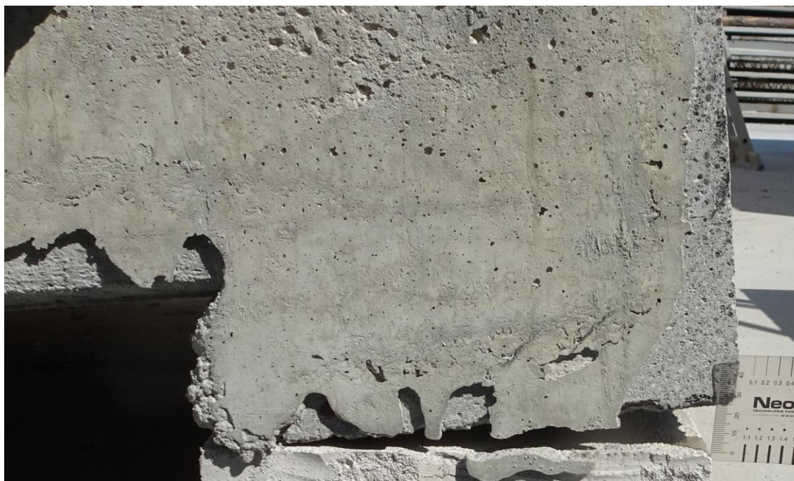
Rys. 52. Obrót stropu wraz z wieńcem na podporze
