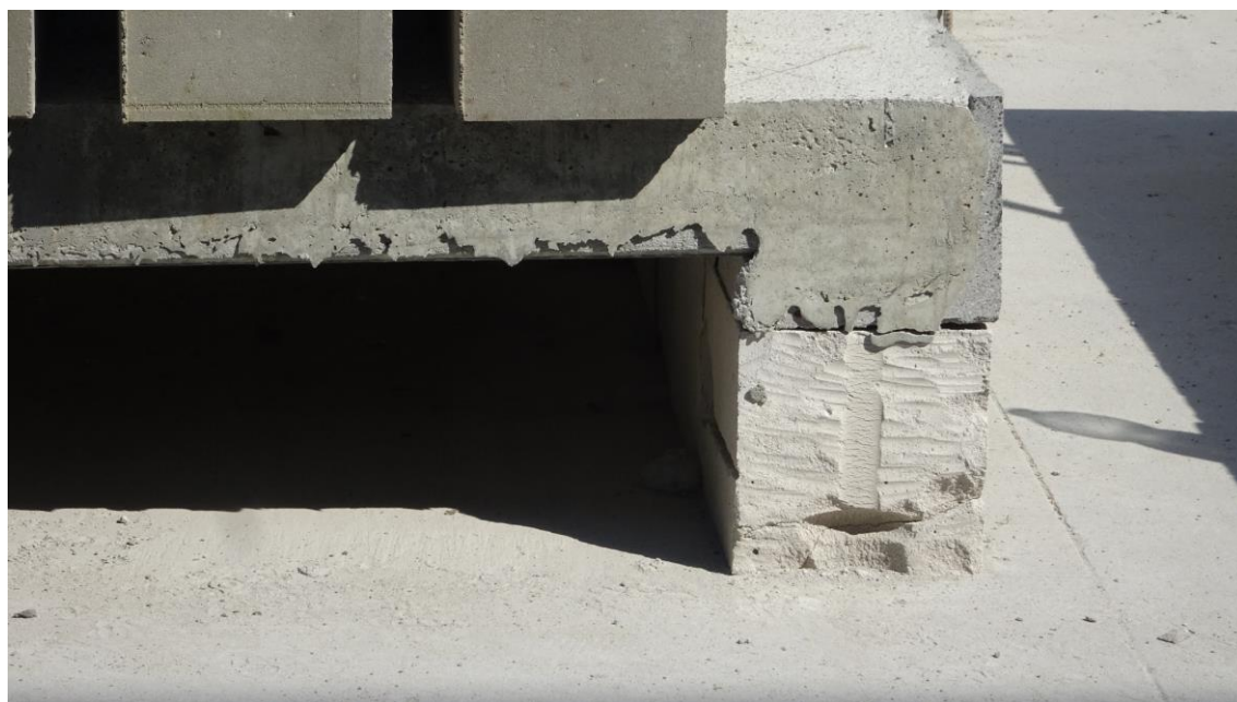
Rys. 46. Obrót na podporze po odczycie 5
