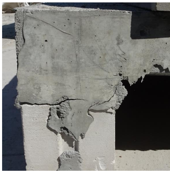
Rys. 48. Zarysowanie spodu płyty oraz obrót na podporze z zarysowaniem kształtki
