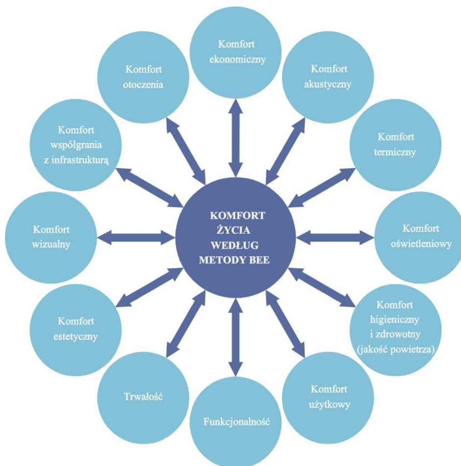
Rys. 3.1. Składowe cechy komfortu życia według metody BEE – oceny budynku pod kątem zrównoważonego budownictwa, opracowanej przez Instytut Techniki Budowlanej [54]
